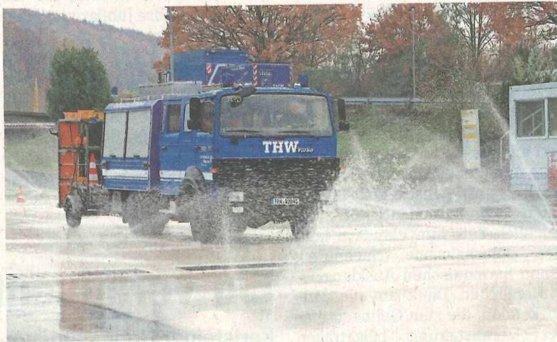
Gerätekraftwagen GKW-2 mit Verkehrssicherungsanhänger bei Vollbremsung auf glattem Untergrund.
